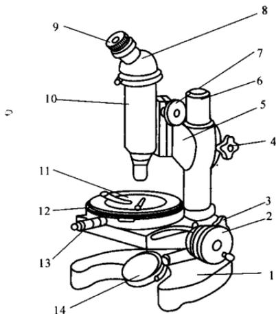
图4 测量显微镜外形图
