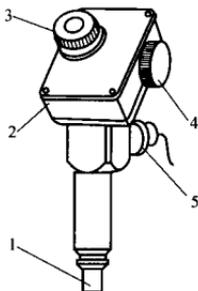
图 1 读数显微镜外形图之一
